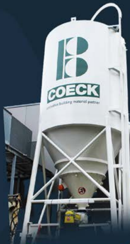
Silo à ciment
